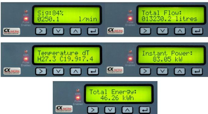
Nach Eingabe der Messstellenparameter startet der CLOU-1000E MK2 sofort den Signalabgleich. Nachdem ein gültiges Signal erkannt ist, werden die Signalstärke sowie der aktuelle Momentanwert angezeigt. Die aktuelle Fließrichtung wird als positive Richtung definiert. Im Bedienmenü können weitere Einstellungen wie die Skalierung des Zählimpulsausgangs oder der Schleichmengenunterdrückung vorgenommen werden. Um versehentliche Änderungen zu verhindern, ist die Bedienung passwortgeschützt.
