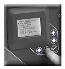
Das Parametriermenü ist einfach über 5 Tasten zu steuern. Die Pfeiltasten führen durch das Menü, das in drei Sprachen wählbar ist (Englisch, Französisch, Spanisch). Durch den integrierten Passwortschutz können die getätigten Einstellung und die Bildschirmeinstellung gesichert werden.
